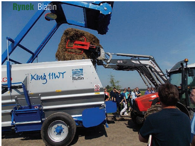
Wozy paszowe Blattin King charakteryzują się bogatym wyposażeniem standardowym - między innymi wałek wsteczny ślimaków (możliwość cofnięcia ślimaków) i śruba bezpieczeństwa (zabezpiecza przekładnię przed uszkodzeniami)
