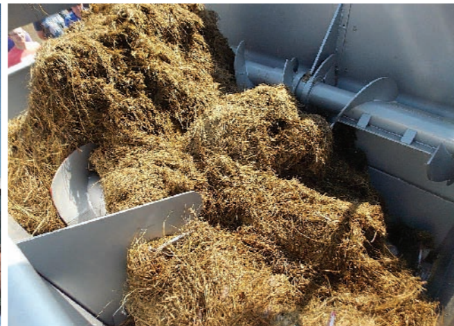
Wozy paszowe Blattin King charakteryzują się bogatym wyposażeniem standardowym - między innymi wałek wsteczny ślimaków (możliwość cofnięcia ślimaków) i śruba bezpieczeństwa (zabezpiecza przekładnię przed uszkodzeniami)
