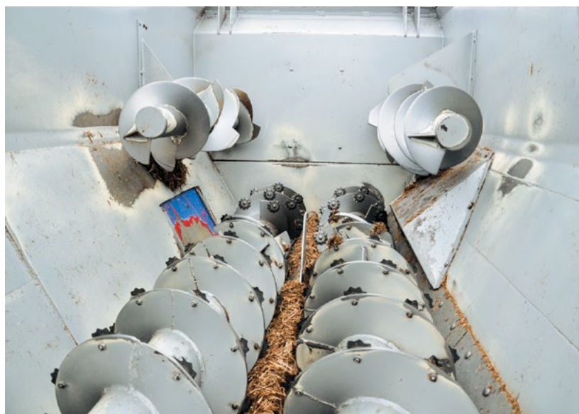
Poziomy wóz firmy ZAGO posiada opatentowany system ślimaków, dolne mieszają i rozdrabniają pasze, a górne tylko mieszają
