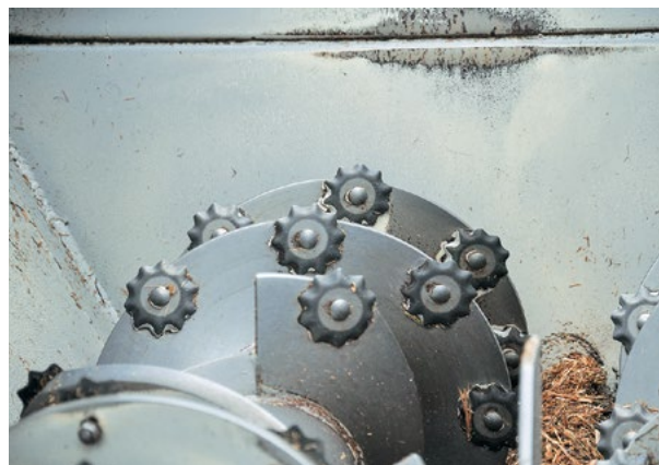
W poziomym wozie paszowym noże umieszczone są na obwodzie dolnych ślimaków
