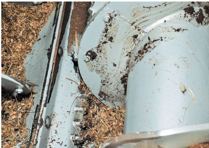
Przeciwnoże w poziomym wozie paszowym znajdują się na listwie przymocowanej do dna zbiornika
